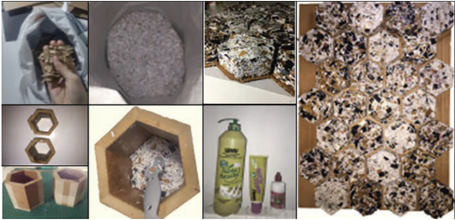
Resim 6. Çalışma 5: Atık kâğıt ve mukavva kırıntılarından tasarlanan duvar paneli
